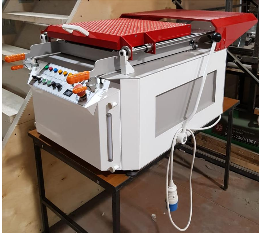
Рис. 1. Термовакuumная формовочная машина - формовочный станок 500x500 FormCraft 500.
